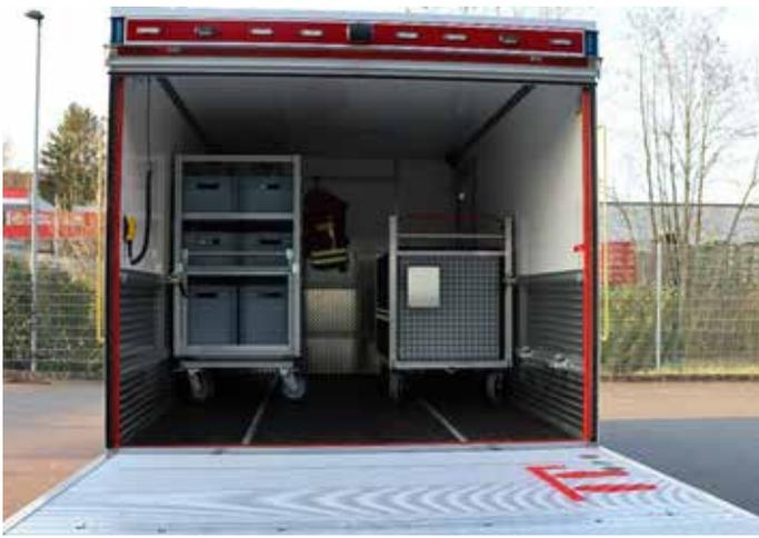
container vorgehalten: • Schlauchmodul mit 500m B-Schlauch und drei C-Schlauchtragekörben • Lichtmodul mit Stromgenerator und Halogenstrahlern inkl. Zubehör • TS-Modul mit Tragkraftspritze und vier Saugschläuchen • Unwettermodul mit zwei Wassersaugern • Gitterbox mit Kunststoffbehälter • Hygiene-Modul • Waldbrand-Modul • Sandsäcke
