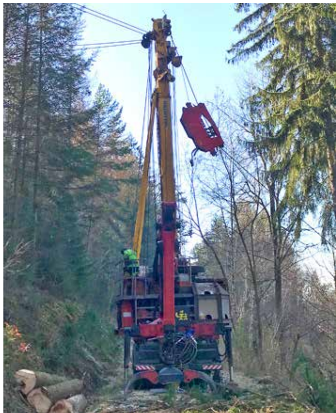
Der rote Laufwagen transportiert die Holzstämme aus dem steilen Hang an Waldweg wie an einem Schlepplift. Quelle: Landratsamt Rhein-Neckar-Kreis
